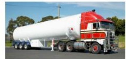
LNG trailer 50 m³, China
